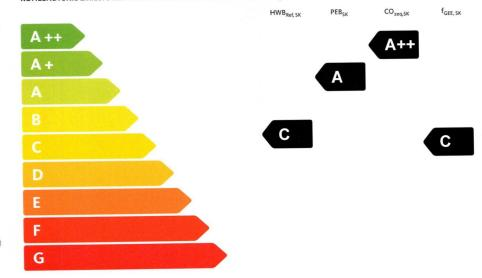
HWB<sub>Ref</sub>: Der Referenz-Heizwärmebedarf ist jene Wärmemenge, die in den Räumen bereitgesteilt werden muss, um diese auf einer normativ geforderten Raumtemperatur, ohne Berücksichtigung allfälliger Erträge aus Wärmerückgewinnung, zu halten.
