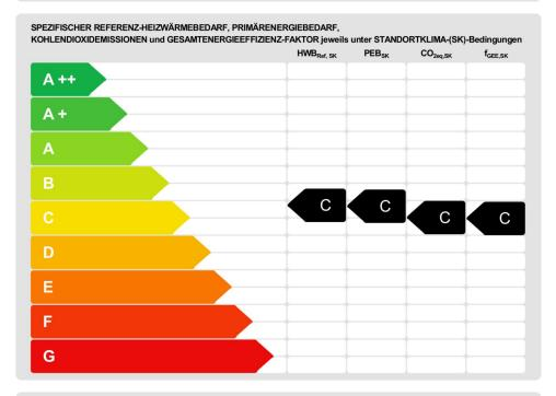
HWB<sub>ac</sub>: Der Referenz-Heizwärmebedarf ist jene Wärmemenge, die in den Räumen bereitgestellt werden muss, um diese auf einer normativ geforderen Raumemperatur, ohne Berückschitigung alfälligier Erträge aus Wärmerückgewinnung, zu halten.
