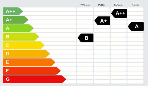
HWBref: Der Referenz-Heizwärmebedarf ist jene Wärmermenge, die in den Räumen bereitgestellt werden muss, um diese auf einer normativ geforderten Raumtemperatur, ohne Berücksichtigung allfälliger Erträge aus Wärmerückgewinnung, zu halten.
